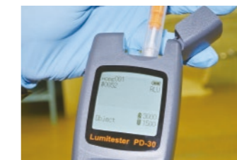
ルミテスター(計測器具)によるATP+AMP計測
