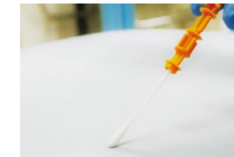
ルシバックペン(採取器具)によるATP+AMP計測
