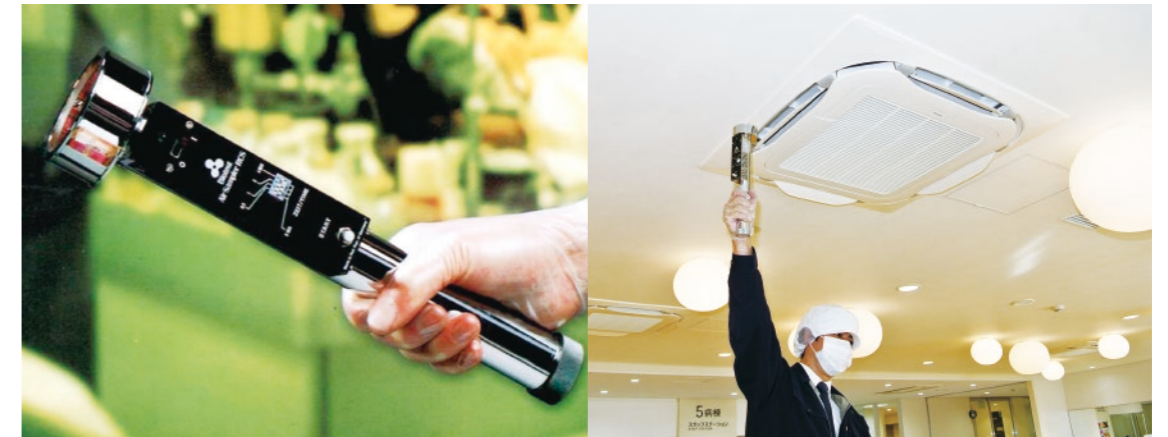
エアースンプラーで空気を一定量採取後、培地で培養して菌やカビなどを可視化して計測
